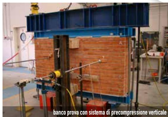
banco prova con sistema di precompressione verticale
