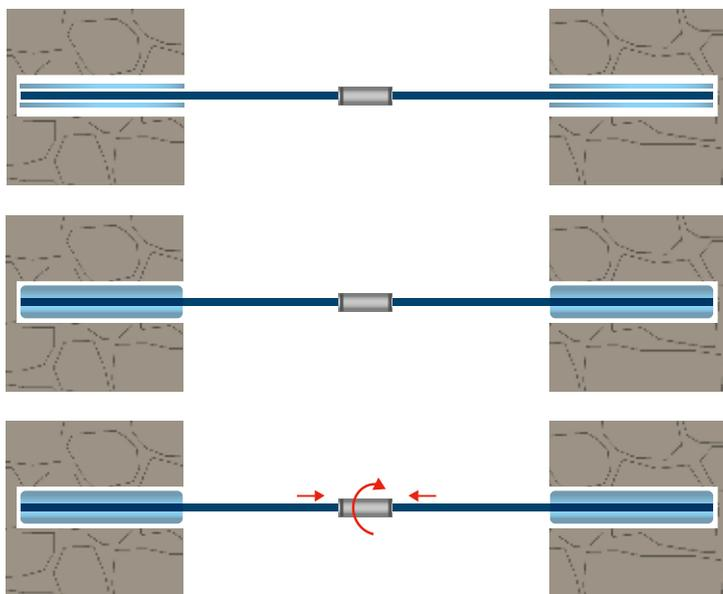
a. assemblaggio catena, mediante inserimento manicotto tenditore e posizionamento estremità con bulbi di ancoraggio all'interno dei perfori realizzati nella muratura
